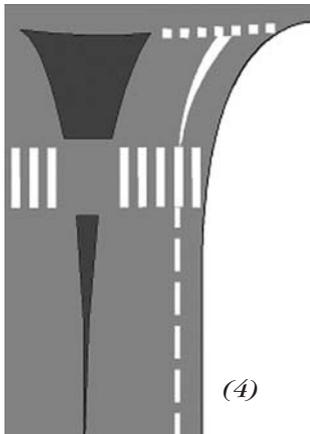
Cette solution (schéma 4) permet une insertion protégée du cycliste sur l'anneau et lui évite d'être coincé contre la bordure du trottoir par des poids lourds.
